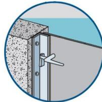
**Figura 50:** Detalles de barrera impermeable de protección de equipos con puerta estanca vista desde el interior (FEMA)
